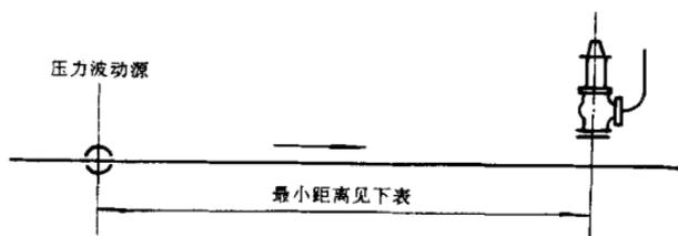
图 16.0.12 安全阀距震动源的最小距离
