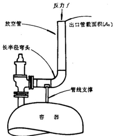
图 16.0.14 出口反力示意图
