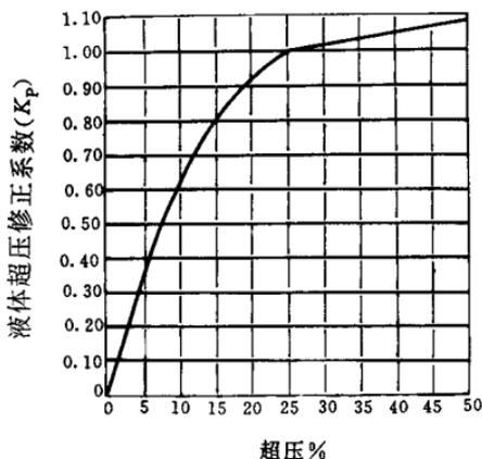
图 16.0.9 液体超压修正系数( $K_p$ )图
