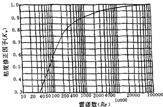
图 16.0.11 液体粘度修正系数 ( $K_v$ ) 图
