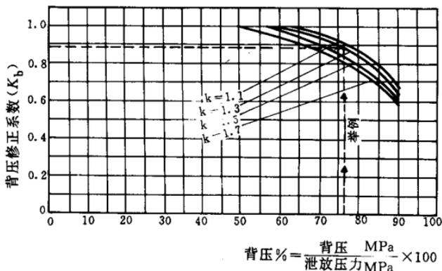
图 16.0.8 弹簧式安全阀背压修正系数( $K_b$ )图
