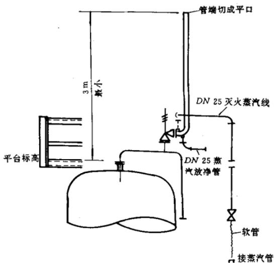
图 16.0.13 安全阀的灭火蒸汽管示意图
